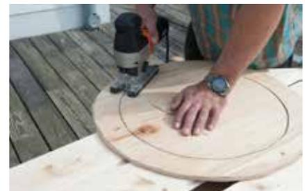
**6.** Aus dem Sperrholz die Scheiben für die Bullaugen zuschneiden (Ø 500) und den Innenkreis (Ø 400 mm) ausschneiden. Für den Ansatz der Stichsäge am Innenkreis ein Loch bohren und die Ringe zuschneiden.
