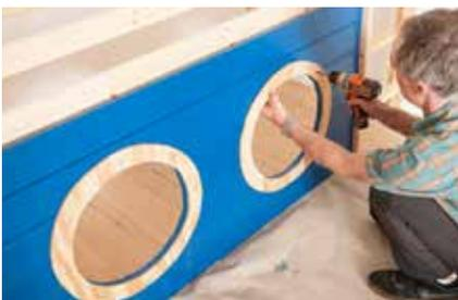
**16.** Die Linsenkopfschrauben sind reine Deko-Elemente und werden eingeklebt. Dazu in regelmäßigen Abständen acht Löcher durch die Bullaugenrahmen bohren.
