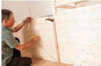
**2.** Fürs Anzeichnen der Bug-Rundung die Profilhölzer zusammenstecken und mit Zwingen an den Bettpfosten fixieren. Ermittlung der Rundung: Hilfsleiste mit Zwinde auf den Profilhölzern befestigen. Mit Hilfe des gebogenen Zollstocks die Rundung anzeichnen (obere Länge s. Maßskizze).
