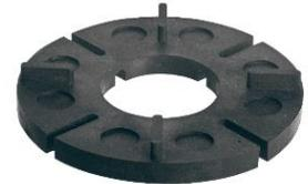
Die wasserabweisenden, feuchtigkeitsresistenten Plattenlager werden eingesetzt für die einfachste Verlegung der CEWO-Deck Terrassenplatten. Sie bilden einen Abstand zum Boden (10 – 30 mm) und durch das Fugenkreuz auch zwischen den Platten (Fugensteg 4 mm), wodurch eine trittschalldämmende und frostsichere Verlegung gewährleistet wird.
