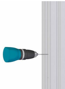
anzeichnen, ankörnen und vorbohren ...
