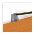
Clip ansetzen und Bohrloch markieren
