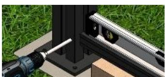
Bohrungen mit dem Ø 10 mm Bohrer:
