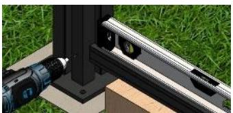
Bohrungen mit dem Ø 4 mm HSS-Bohrer:
