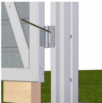
(1) Schraubpunkte anzeichnen/ korkören...
