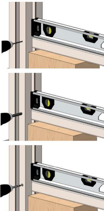
Bohrungen mit dem Ø 4 mm HSS-Bohrer:
