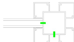
Setzen Sie jetzt das Aluminium-Lichtprofil auf das BPC-Profil, das Anschlusskabel führen Sie durch die beiden Bohrungen in die ungenutzte Pfostennut. Das Lichtprofil mittig muss nicht mit den Pfosten verschraubt werden. Die Pfostennut mit dem Kabel können Sie mit einer Aluminium Nut-Abdeckleiste verschließen.
