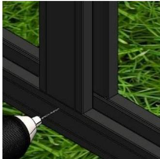
Tipp: Für mehr Stabilität verschrauben Sie das H-Profil rückseitig mit dem Start- und mit dem Abschlussprofil. Bohren Sie dafür mit einem Ø 4 mm Bohrer auf der Ziernut des Start- und des Abschlussprofils mittig des H-Profil-Montagezapfens vor (Startprofil (unten) -> obere Ziernut / Abschlussprofil (oben) -> untere Ziernut). Verschrauben Sie die Aluminiumprofile oben und unten mit je einer selbstbohrenden Linsenkopfschrauben 4,8 x 45 mm.
