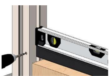
Bohrungen mit dem Ø 4 mm HSS-Bohrer:
