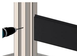
Bohrungen mit dem Ø 4 mm HSS-Bohrer:
