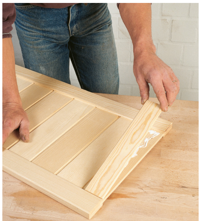
Möbelzuschneidetüren: Anleimen der Rahmenabschlussleiste
